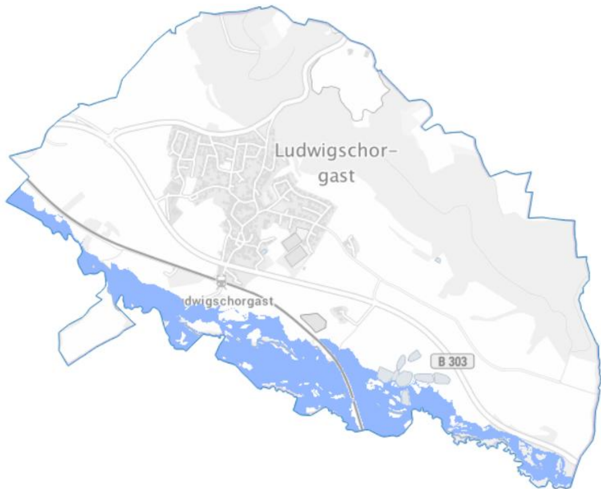
Abbildung 26: Hochwassergefahrenflächen HQ100 in der Marktgemeinde Ludwigschorgast [9] [32]
